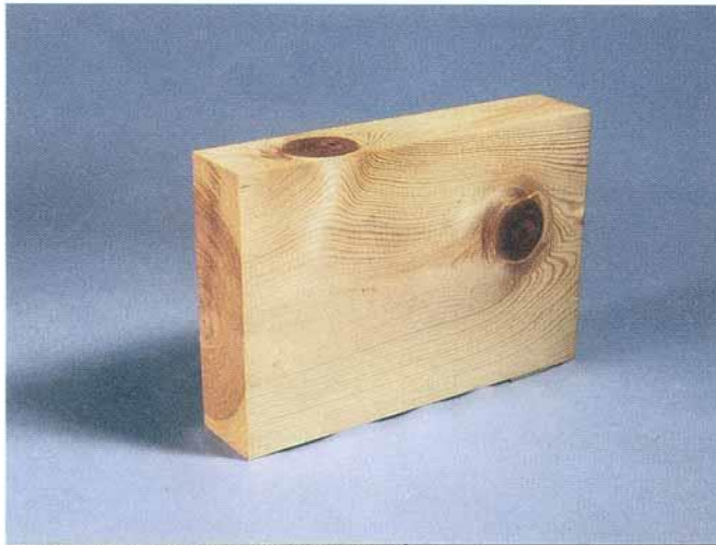
Figur 5: Flatside- og kantsidekvist Figure 5: Face knot and edge knot
